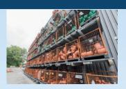
Die Gitterboxpalette ist genormt und muss mit dem Namen des Herstellers und dem Baujahr gekennzeichnet sein. Mit Abmessungen im Außenmaß von 1240 mm x 835 mm x 970 mm ( $I \times b \times h$ ) und einer Traglast von bis zu 1.500 kg ist sie in der Lagerlogistik vor allem für schwere und sperrige Artikel geeignet, wie beispielsweise Fertigungsteile oder Produktionsabfälle.
