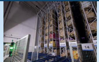
Im Klartext: Ein automatisches Kleinteilelager (AKL) ermöglicht den voll-automatisierten Betrieb sowie die Steuerung mittels Regalbediengeräten oder sog. Shuttles (autonomes Lagerfahrzeug).
